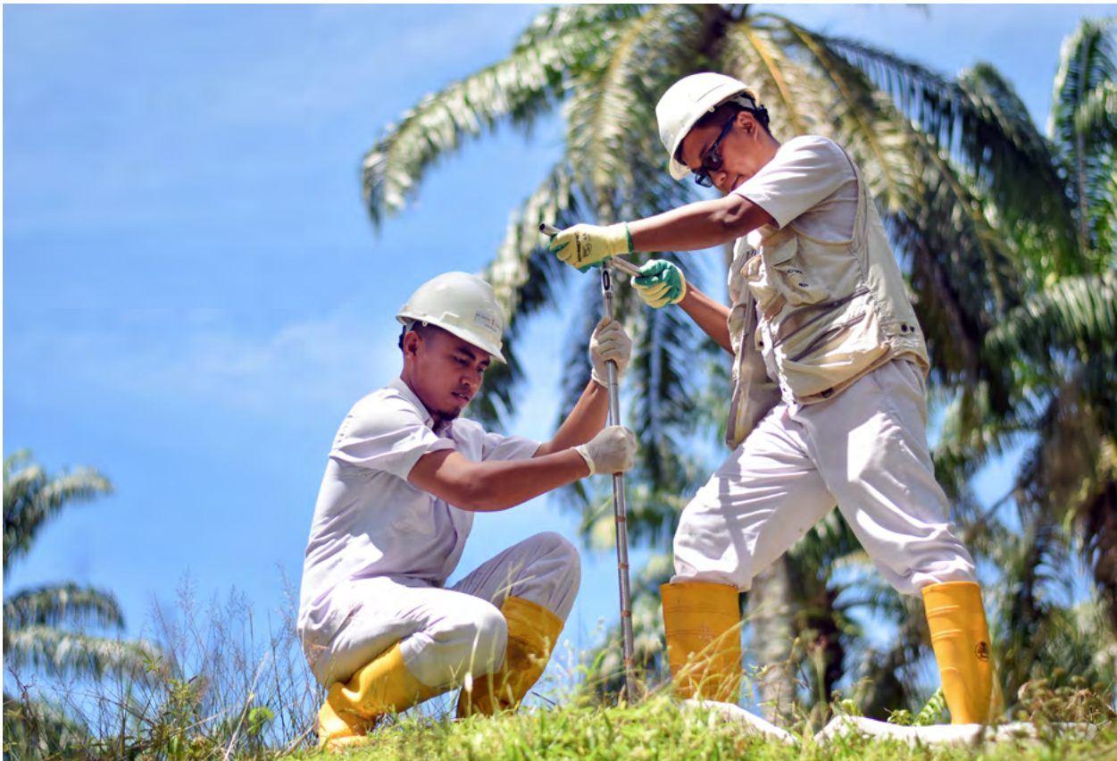
📷 Tim SSPL Socfindo sedang bekerja, mengambil sampel tanah untuk dianalisis lebih lanjut.
